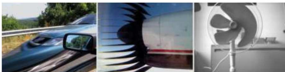
Рис. 4. Искажения, вызванные съёмкой камеры со строковым затвором.
